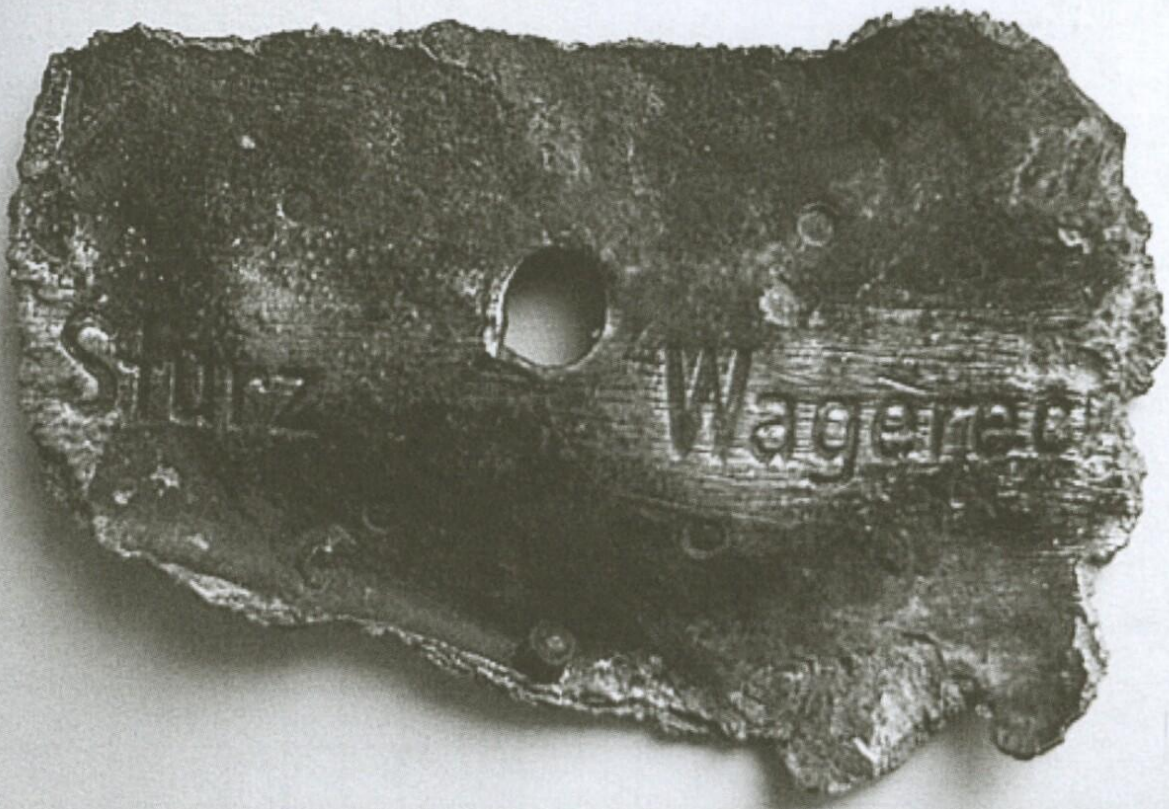
FRAGMENT PLECHU PANELU ODHOZU PUM (CCA 10 X 8 CM) Z KOKPITU STROJE SEŠTŘELENÉHO NAD PODOLÍM; DÍKY NÁLEZU TOHOTO FRAGMENTU SE PODAŘILO POTVRDIT, ŽE SE JEDNALO O STÍHAČKU Fw 190, JEJÍ BITEVNÍ VARIANTU OZNAČOVANOU PÍSMENEM F
