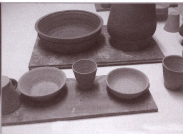
VYTOČENÉ A ČÁSTEČNĚ VYSUŠENÉ PŘEDMĚTY URČENÉ K PRVNÍMU VÝPALU (FOTO P. HAD)
